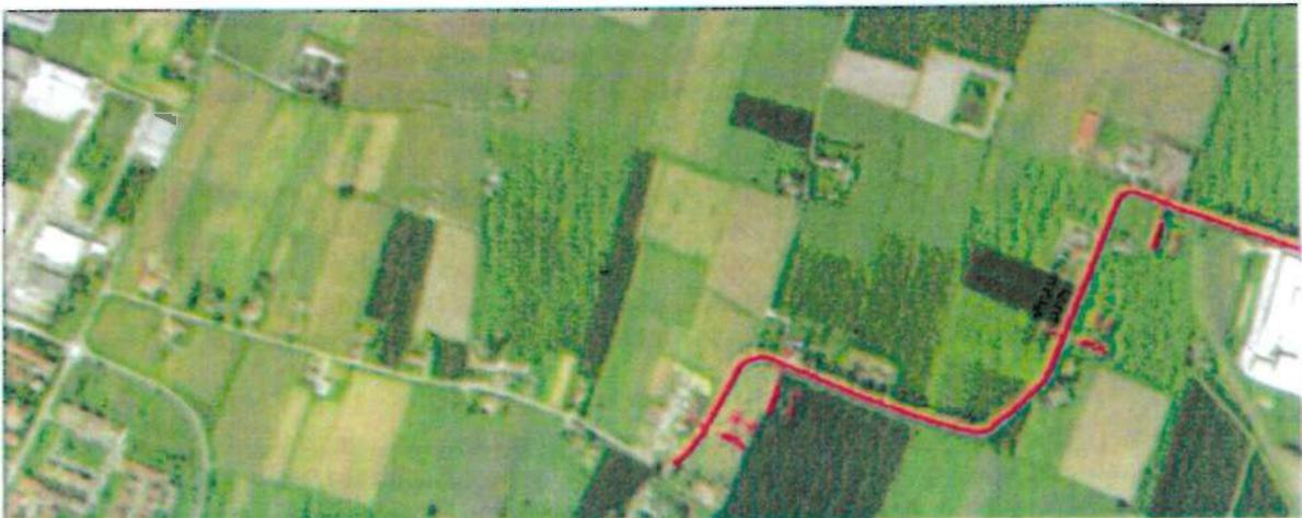
Figura 1: Tratto di Via Carpi in cui sarà effettuato il tombamento della Fossetta di Trignano.
