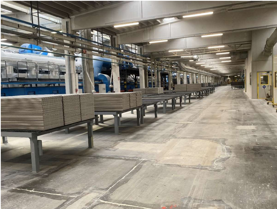
Foto 1 - attuale stoccaggio lastre semilavorate su un solo banco in attesa di lavorazione finale. Il nuovo progetto prevede lo stoccaggio dei bancali in verticale su più file H= 14 m
