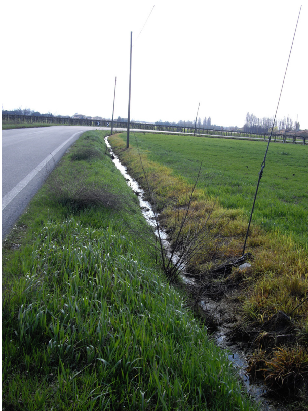
Foto 16 VIA CARPI ESISTENTE - da allargare e rivestire con canalette in cls
